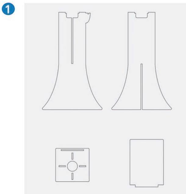
Ce support en colonne est muni de deux pieds portants, d'une étagère de gel et d'une plaque arrière.
